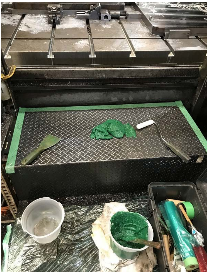
[写真-3] 混合した すべり止めコートを塗布面に置いた状態。
