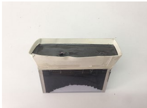
[写真-2] 海外製・鉄粉タイプ液状補修剤隙間流動性試験結果
